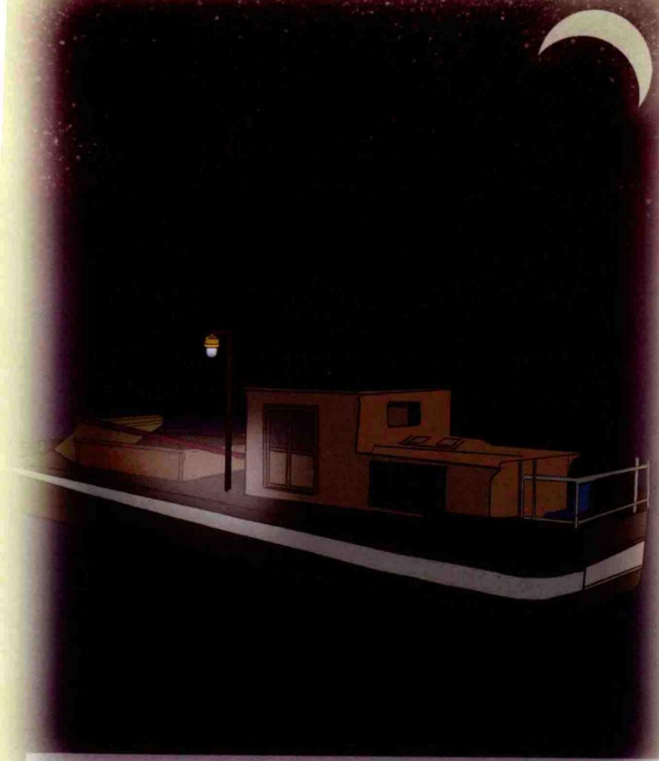
船上在夜间应有照明设备，没有照明设备的船只，应备有防风灯及电池灯具。
