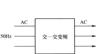
图 1-16 直接（交—交）变频装置
