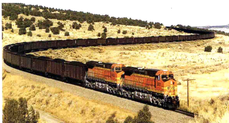
图 1—1—2 BNSF 铁路公司的运煤重载单元列车
