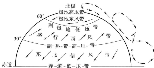
图 2-1 三圈环流示意图
