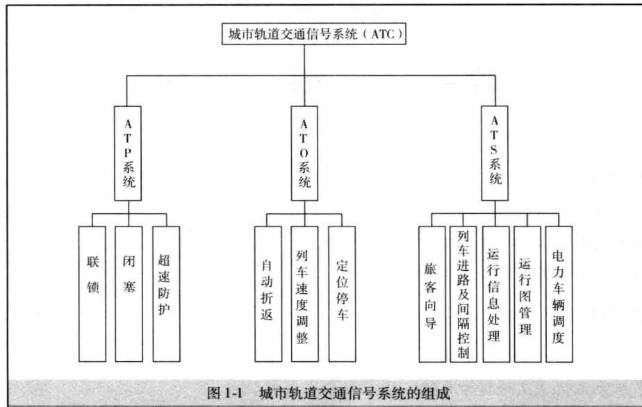
图 1-1 城市轨道交通信号系统的组成
