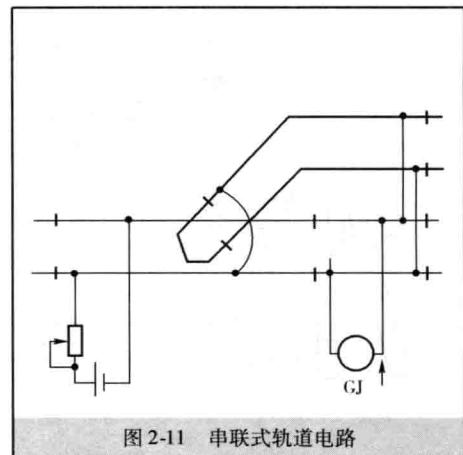
图 2-11 串联式轨道电路
