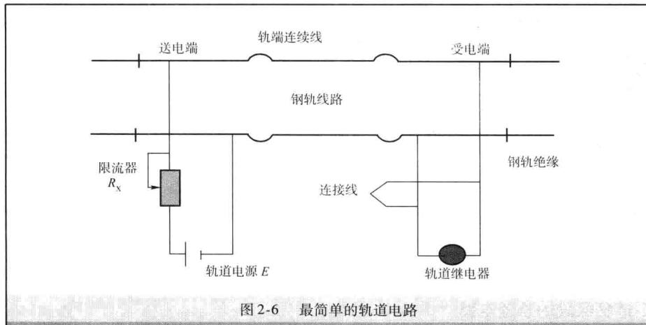
(2) 轨道电路的两端分别设有送电端和轨道继电器(图 2-7),当轨道继电器中有电流时,轨道继电器吸起,继电器前接点和中接点闭合;当轨道继电器没有电流时,轨道继电器落下,后接点和中接点闭合。
