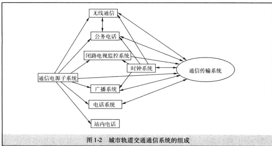
图 1-2 城市轨道交通通信系统的组成
