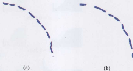
图 6.20 物质点法得到的柱壳破碎形态 (a) 基于 Gurson 模型; (b) 基于宏观随机失效方案
