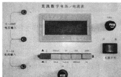
图 1-18 直流数字电压/电流表
