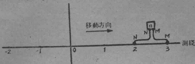
图 15 电位梯度测量装置
