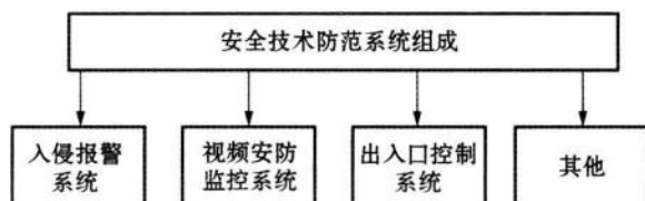
图 1-1 安全技术防范系统的基本组成
