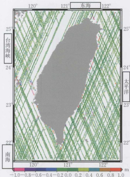
彩图 5.13 台湾岛周边海域 GEOSAT/GM 地面轨迹分布及 ITR 重定后的 SSH 与原始 GDR 的 SSH 比较
