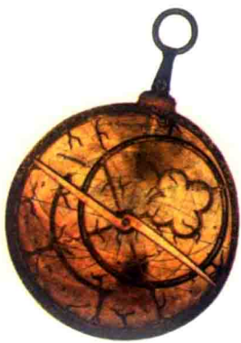
作为16世纪最基本的航海仪器，星盘的功用在于帮助船长们找到特定的星星，从而确定自己所在的位置。
