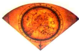
象限仪是16世纪航海探险家最常用的工具，通过对中午时分太阳高度的测量，使用者由此获知自己身处的纬度。
