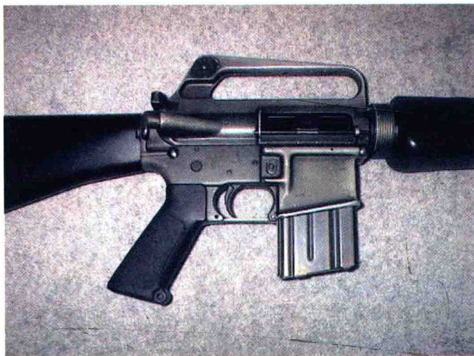
→ M16A1在弹匣解脱钮周围有防止误操作的凸起
