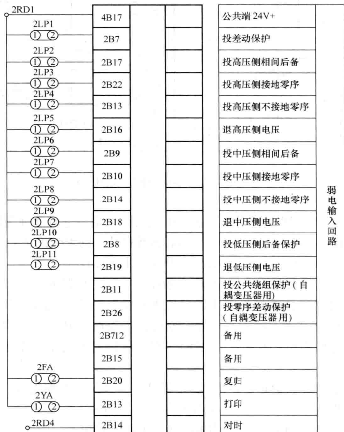
图 1-2 变压器保护装置部分弱电开入量
