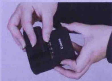
将电池按正确的方向插入充电器
