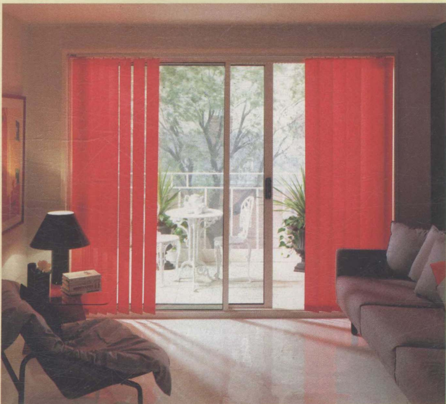
客廳百葉窗簾 通往庭園的落地拉窗，配上豎式百葉窗簾，既實用又美觀。其工作原理與軟百葉窗簾一樣，可調節光線的明暗。每一葉片底部都加重，以保持垂直。這種百葉窗簾可以按需要定做。
