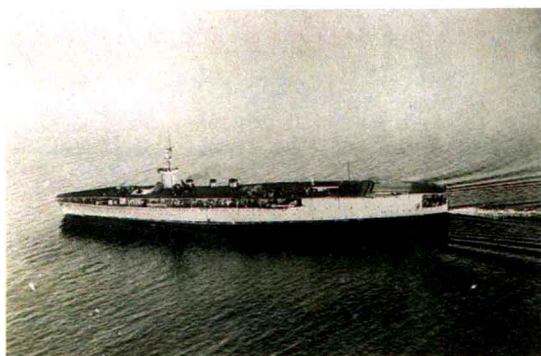
1922年服役于日本海军的“凤翔”号航空母舰，从建造之初就是作为全通甲板搭载飞机的“特务舰”而设计的。（日本当时还没有航母这一舰种）这是日本设计的最早的航空母舰。 照片提供：史密森尼研究所
