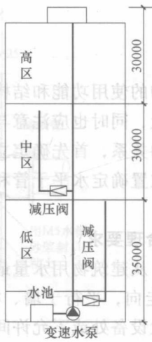
图 1-11 水泵减压阀给水方式
