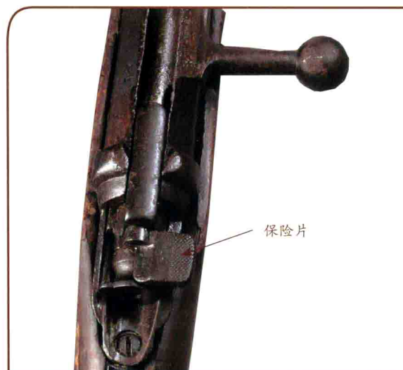
13. 保险状态特写。将保险片扳向右侧，保险片上的突出部抵在机体后端面上，阻止击针（机尾）前移，从而形成保险状态。
