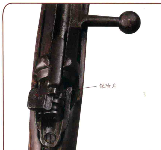
14. 解除保险状态特写。将保险片向左侧，保险片上的突出部从机体尾端移开，不再阻碍击针（机尾）前移，此时扣动扳机即可发射。
