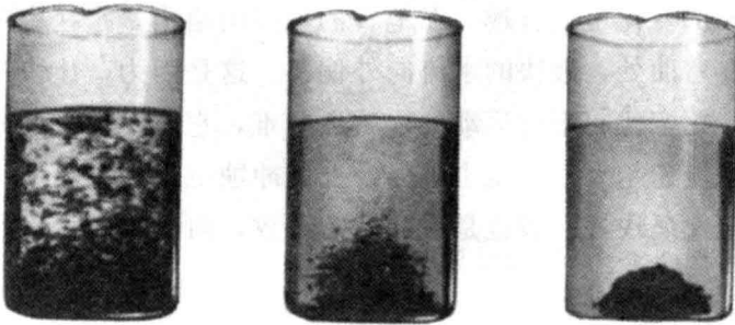
图 1-2 茶杯实验：涡流把茶叶推向杯底中央
