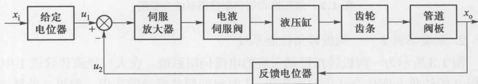
图 1.4 管道流量电液伺服系统方框图
