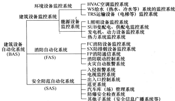
图 1-2 建筑设备自动化系统
