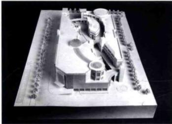
购物中心的四个入口皆面向都市开放。由高差变化而形成的阶梯步道串联起不同标高的层面，这一手法化解了基地高差带来的议题，创造了各层商业价值的均好性。
