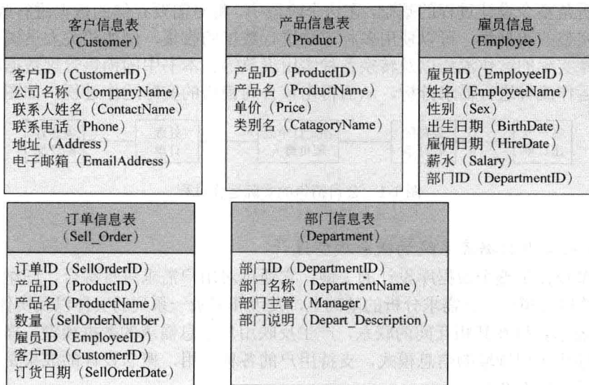
图 1-3 将 E-R 图转换后的逻辑模式
