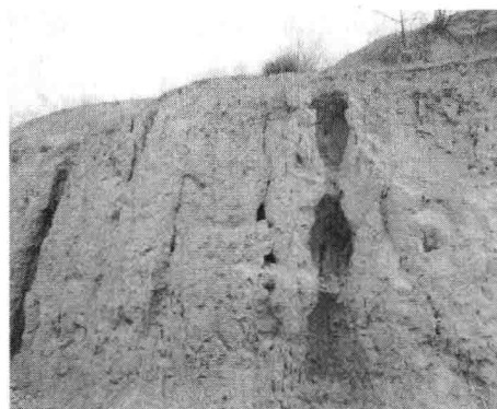
图 1-5 黄土大孔隙和发育的垂直节理
