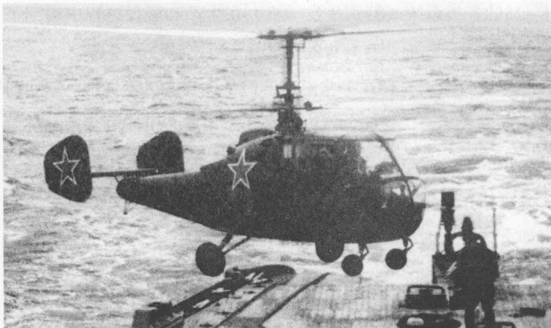
一架涂有1955年之前标志（机身和尾翼上有红五星）的卡-15通信联络直升机正在一艘驱逐舰的甲板上着陆。
