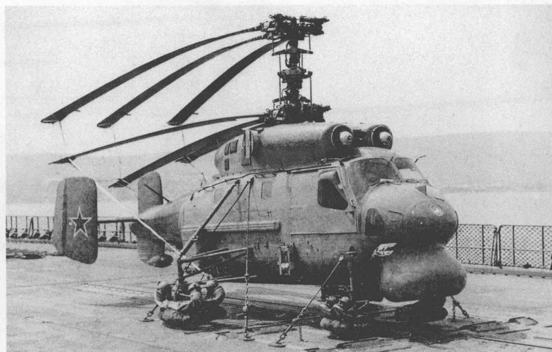
一架未编号的卡-25PL，用绳索固定在“莫斯科”号航母上，旋翼系统折叠。它展示了该机的外形布局，两台发动机位于旋翼减速器前面。
