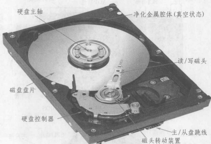
图 1.8 硬盘的内部结构
