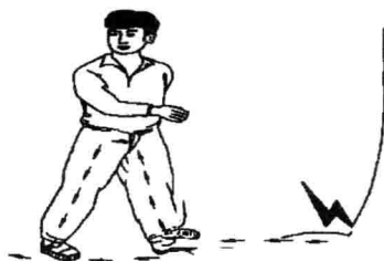
图 1-5 跨步电压触电
