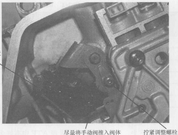
图 1-2 01N 自动变速器手动阀位置调整
