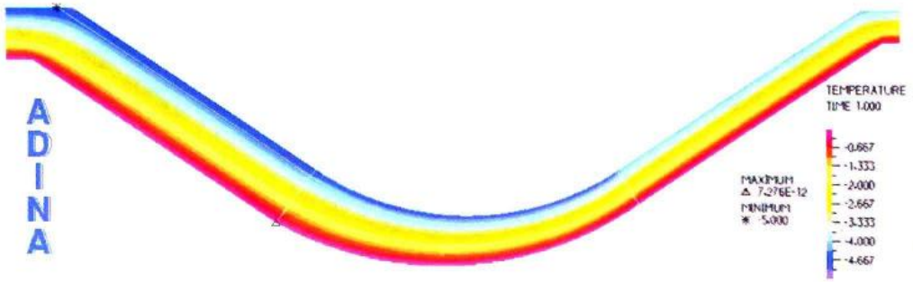
彩图 7 渠道温度场云图 (单位: °C)
