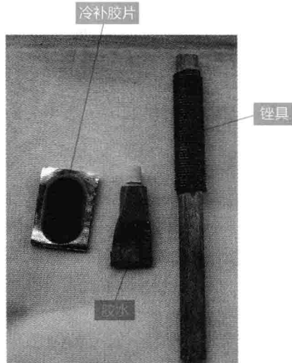
图 1-27 冷补胶片、胶水和锉具
