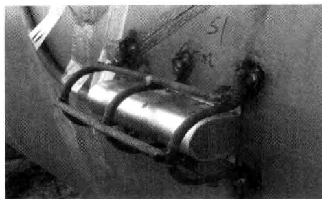
图 9 安装在钢管表面的钢弦式应变计
