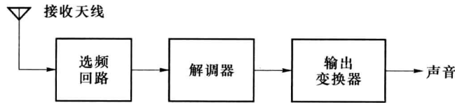
图 1-1-4 最简单的接收机组成框图
