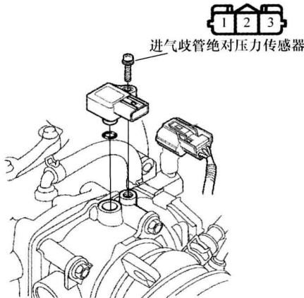
图 1-1-9 进气歧管绝对压力传感器安装位置及传感器端子识别
