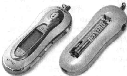
▲与普通闪盘相比,由于内置电池,带 MP3 功能的闪盘体积明显增大
