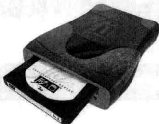
▲这是一个 2GB 容量的 Jaz 驱动器，但它也兼容 1GB 容量的盘片
