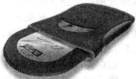
▲按照接口的不同，ZIP 驱动器分为几类，大致有 SCSI、USB、并口和 ATAPI 几种类型
