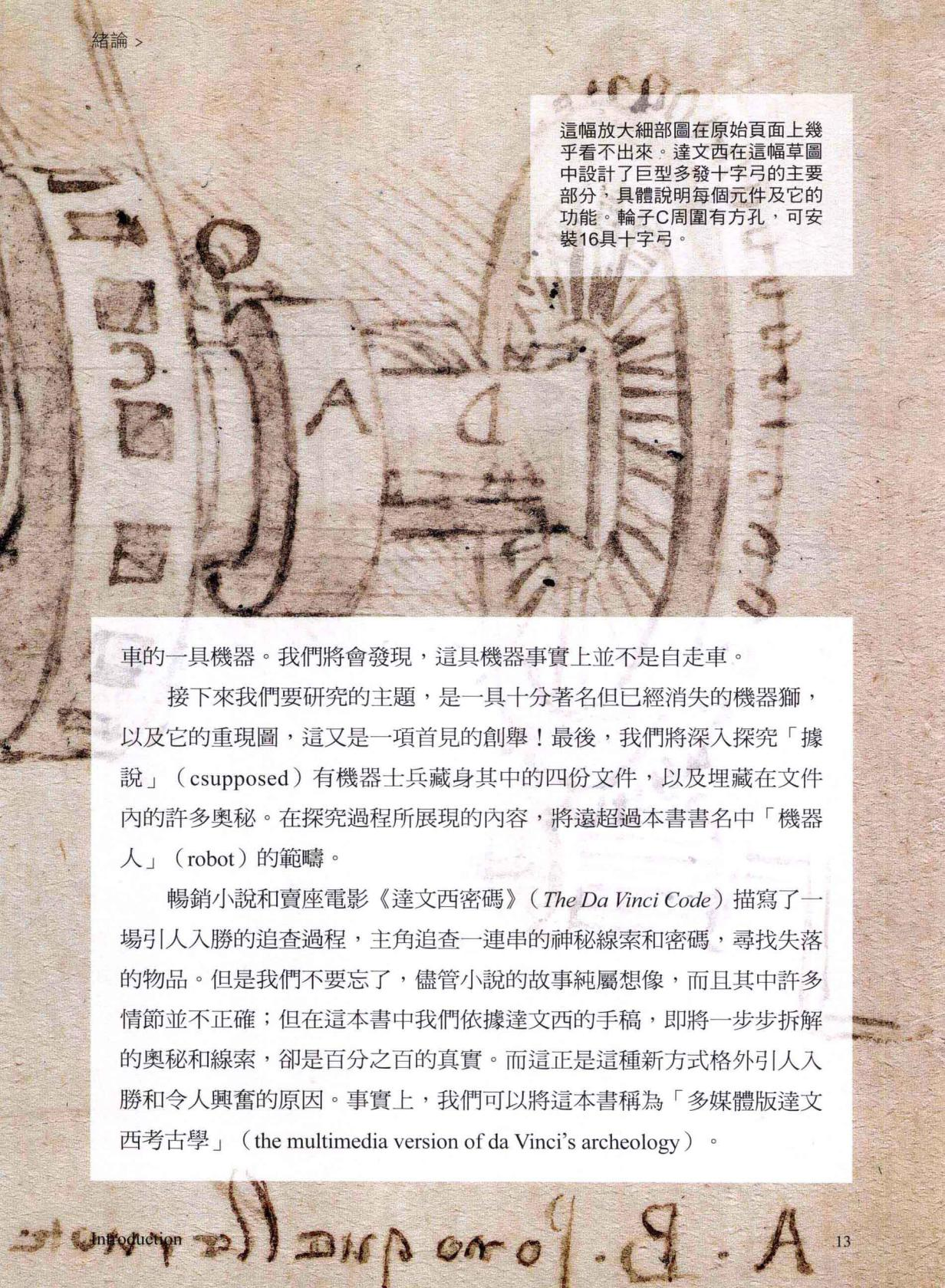
這幅放大細部圖在原始頁面上幾乎看不出來。達文西在這幅草圖中設計了巨型多發十字弓的主要部分，具體說明每個元件及它的功能。輪子C周圍有方孔，可安裝16具十字弓。
