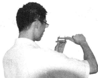
图 1—2—5 游标卡尺测量方法
