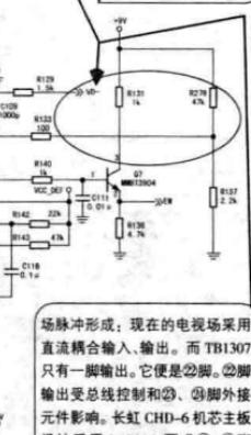
场脉冲形成：现在的电视场采用直流通耦合输入、输出。而 TB1307 只有一脚输出。它是⑫脚。⑫脚输出受总线控制和⑬、⑭脚外接元件影响。长虹 CHD-6 机芯主板场块采用 LA7846，要求⑯、⑰脚都有信号流入，至少直流电平应当接近，送往场偏转电流才会最大。
