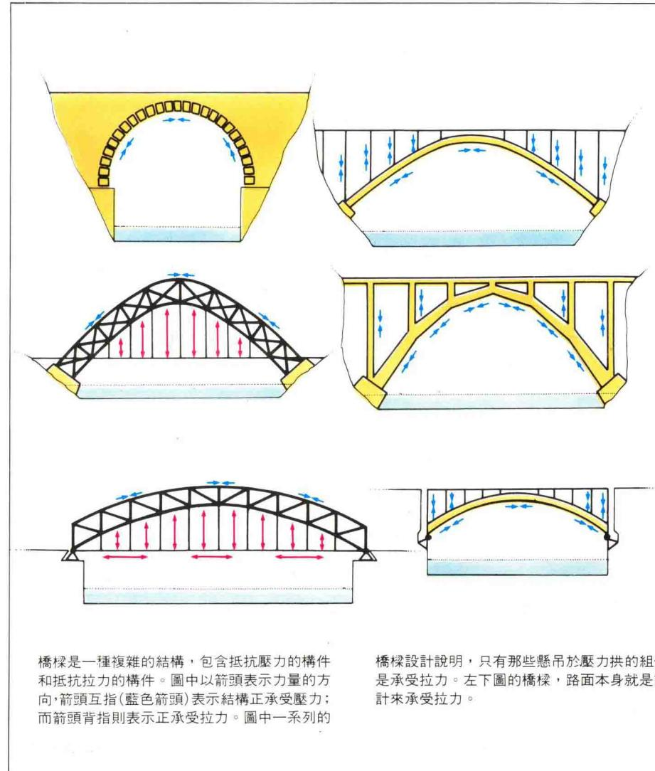
橋樑是一種複雜的結構，包含抵抗壓力的構件和抵抗拉力的構件。圖中以箭頭表示力量的方向，箭頭互指(藍色箭頭)表示結構正承受壓力；而箭頭背指則表示正承受拉力。圖中一系列的
