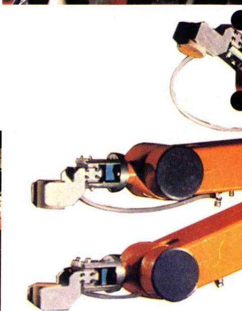
手臂裝置在可旋轉的關節上，具有手指，能抓、能握、能舉、能放等功能，這些功能都是由電腦(computer)控制。特殊的感測器，使機器人能夠感覺熱、壓力和阻力，同時在小範圍內有大略能辨識物體的視覺。雖然機器人的模樣有些笨拙，但它可以固定在裝配線上工作，或是移動。
