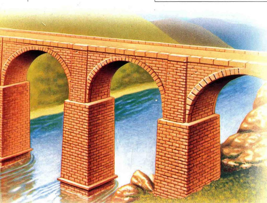
力。壓力就是將物質壓縮聚集在一起的力量，而拉力恰好相反，是將物質拉張分開的力量。樑式橋施於橋柱上的是直接向下力量，即為壓力；而樑的部分則同時承受壓力和張力。在樑的中間部分，由於離支承點最遠，因此有彎曲下陷的趨向。如此樑的上面部分就承受了壓力，而下面部分則承受張力。至於懸掛式橋，施於懸掛索上的則完全是拉力，橋索受力拉張時，兩端的支承點受力最大。施於拱橋上的應力與懸掛式橋相反，完全是壓力—橋身的重量同時向下方和外方施力。
