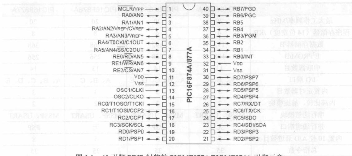
图 1.1 40 引脚 PDIP 封装的 PIC16F877A/PIC16F874A 引脚示意
