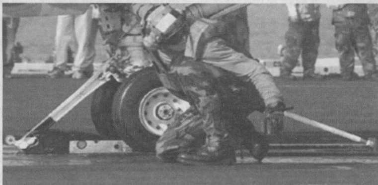
图1-3 前轮拖曳示意图
