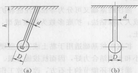
图 1-1-7 爆扩单桩基础形式
