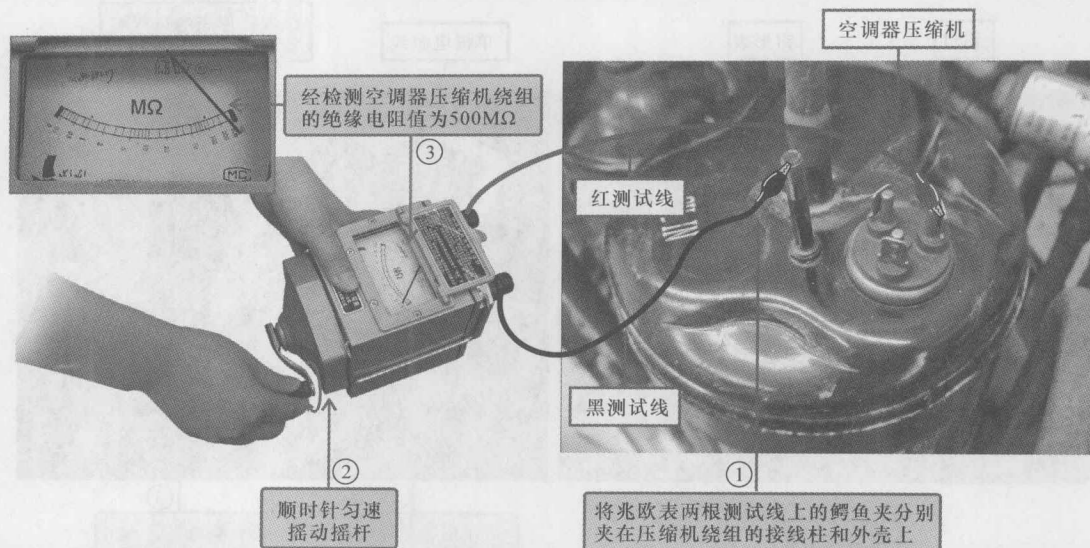
图 1-11 使用兆欧表检测空调器压缩机绕组绝缘电阻的操作示范
