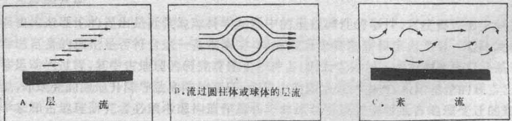
图 1—1 层流和紊流示意图
