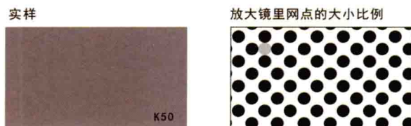
图1-1-7 五成网点印刷实样与网点微观图
