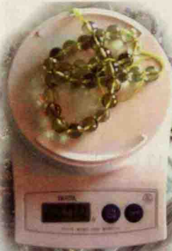
(4) 小型电子秤：精度达到 0.5g，称量 50g 以下的物料。
