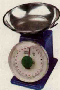
(1) 弹簧秤：50g/4kg 精度，称量 100g 以上的物料
