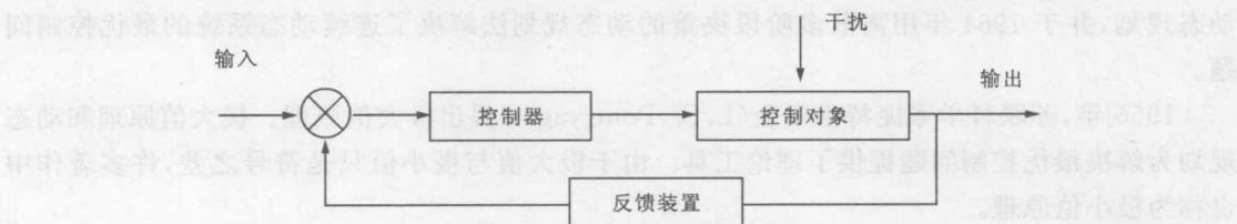
图1-2 反馈控制系统的简化原理框图
