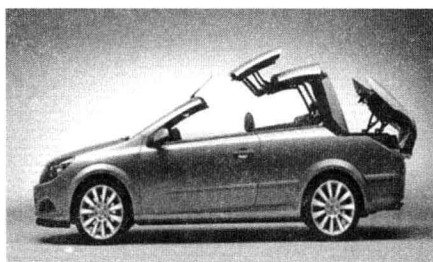
图 1.7 汽车顶篷的折叠和展开状态
