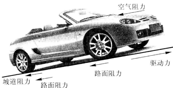
图 1-1 汽车的驱动力和阻力
