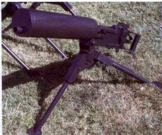
■ M1917重机枪水冷系统与马克沁重机枪相似
