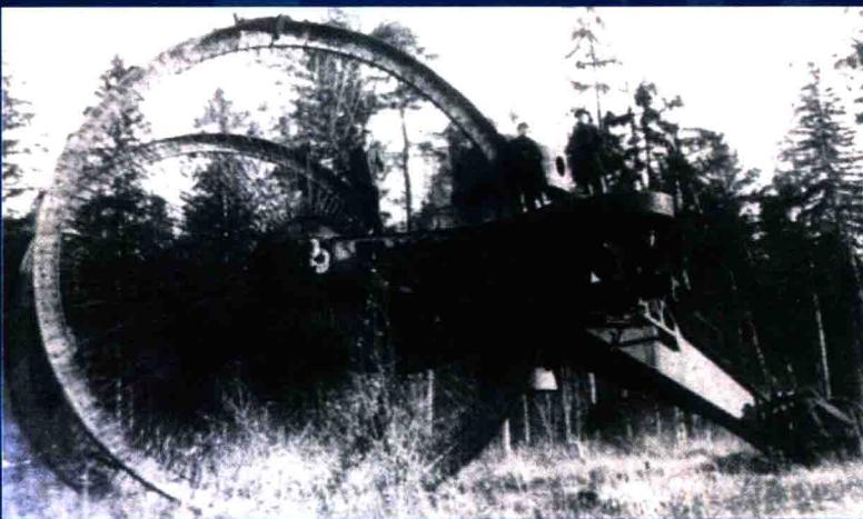
俄国发明的列别坚科轮式坦克（Lebedenko）。车轮直径9米，由250马力汽油发动机驱动，可轻松越过战壕，而且火力发射点很高，便于居高临下发动攻击。1922年完成并交付使用，但是由于其后轮容易陷入沟中，所以后来不再生产。
